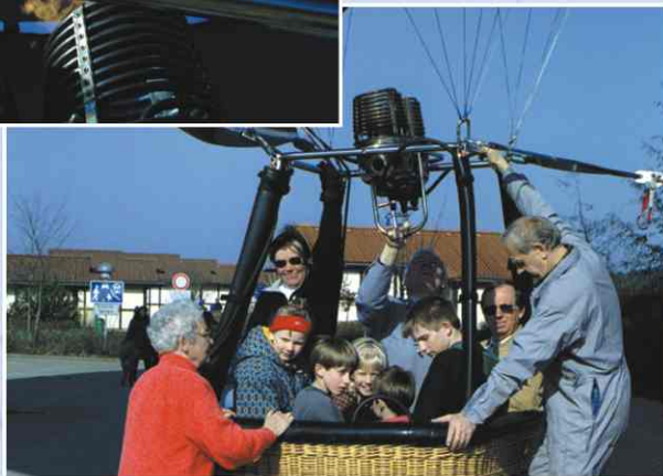
Die Brenner erwärmen die Luft in der Hülle und verleihen somit dem Ballon seinen Auftrieb.
