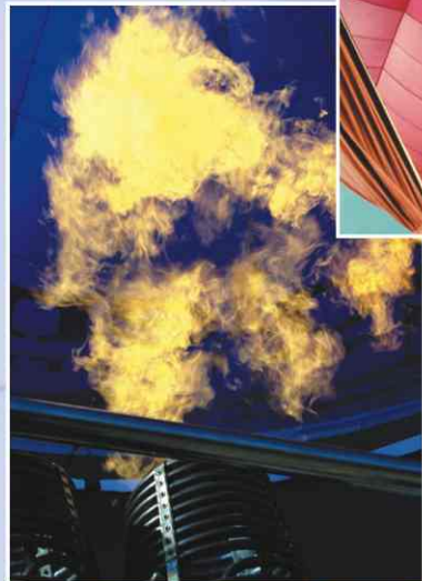
Die Brenner erwärmen die Luft in der Hülle und verleihen somit dem Ballon seinen Auftrieb.
