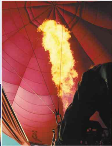
Die Brenner erwärmen die Luft in der Hülle und verleihen somit dem Ballon seinen Auftrieb.
